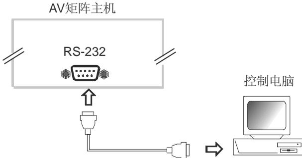
用户可使用系统附带的应用软件作为电脑控制系统, 也可以自行编写控制软件, 详情可参考“VGA 矩阵 RS-232 通讯协议及控制代码”。
